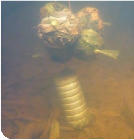
Figure 7 : Dispositif de substrats artificiels immergés durant trois semaines pour permettre aux invertébrés aquatiques de les coloniser. © Bouvier D.
