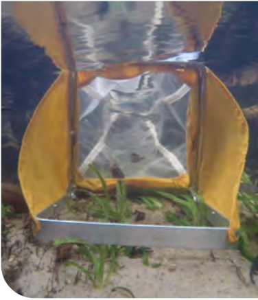
Figure 6 : Le filet Surber est posé au fond du cours d'eau, dans le courant, pour prélever les invertébrés benthiques. © Bouvier D.
